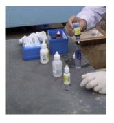
En el caso de utilizar un desinfectante químico (Ej.:cloro) realizará un control del nivel de desinfectante residual
