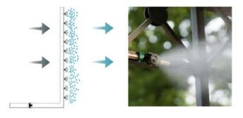
con boquillas que generan microgotas de hasta 5 micras, directamente en las zonas en las que se desea conseguir el efecto de refrigeración, humidificación o incluso a veces un efecto de tipo estético.
