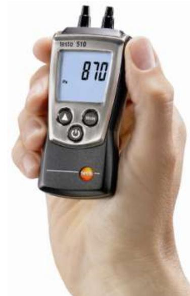
•Con la llave de conexión del aparato abierta y con los mandos del aparato cerrados, se debe realizar la comprobación de la estanqueidad de todas las uniones comprendidas entre la llave de conexión del aparato y el propio aparato, excluido éste, empleando cualquier método cualitativo adecuado al propósito de los indicados en el apartado **6.1 de la norma UNE60670-10/11:2014.**
