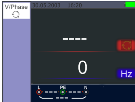
Figura 21 Pantalla inicial de la medición de secuencia de fase
