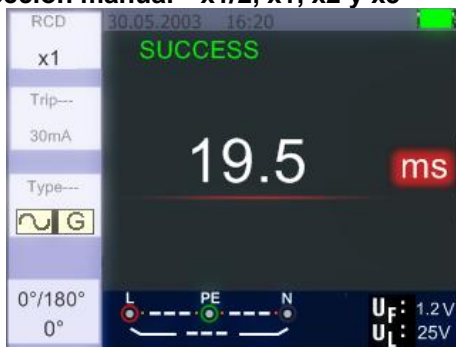
Figura 17 Modo x1 – Pantalla de medición
