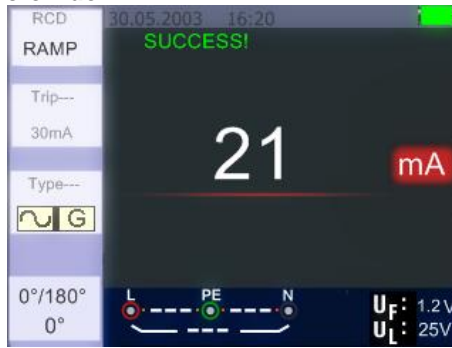
Figura 18. Rampa RCD – Pantalla de medición
