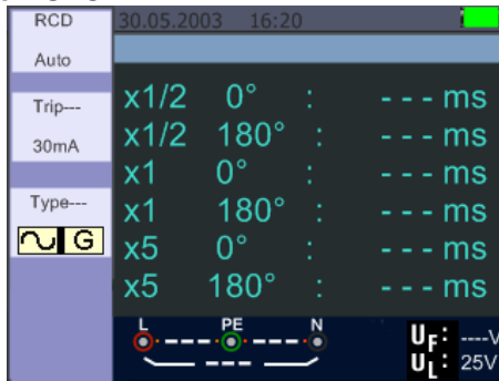
Figura 16. Pantalla de Función Auto RCD
