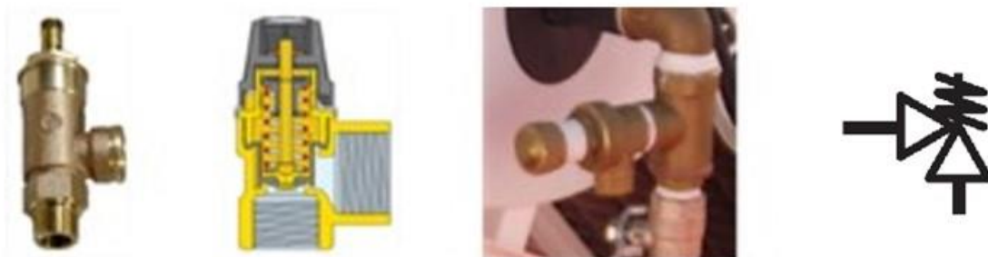
Figura 76: Ejemplo de válvula de seguridad, esquema, instalada y símbolo habitualmente utilizado
