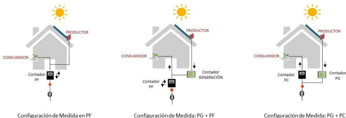
FIGURA C.1. Instalaciones INDIVIDUALES con conexión en RED INTERIOR
