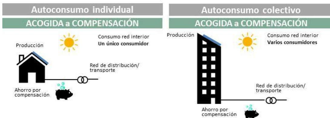
FIGURA 4.3. Diagramas de autoconsumo CON excedentes acogidas a compensación
