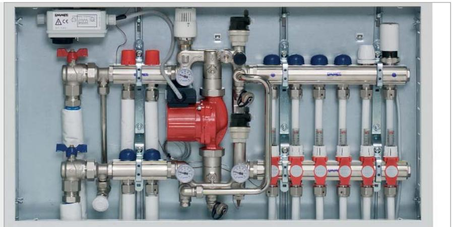
Floor Mixing Unit, conjunto premontado de regulación a punto fijo, con válvula mezcladora termostática a 3 vías, para instalaciones de calefacción a baja temperatura, con soportes de fijación o en caja de metal (para tabique de 120mm).
