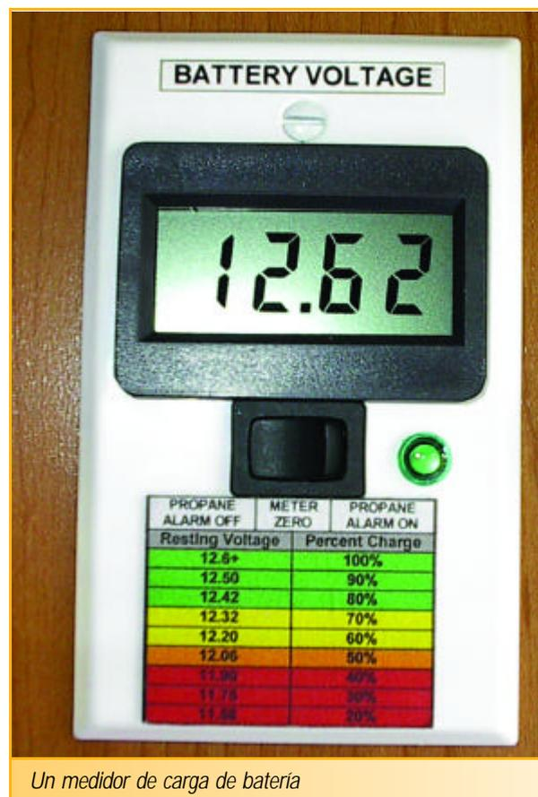
Un medidor de carga de batería
